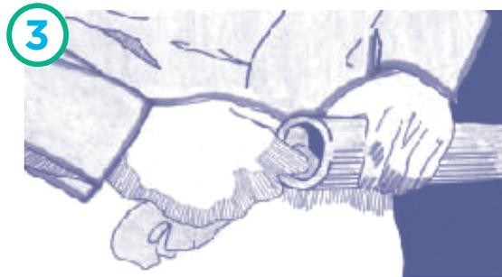
3 Limpie y seque la tubería y el accesorio, usando un pedazo de tela limpio.
